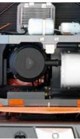
エンジンオイルパンにドレンカプラを装備。備え付けのノズルホースにより、容易にドレン作業が行えます。
