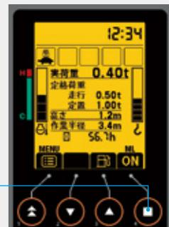
実荷重、定格荷重（走行・定位）、高さ、作業半径を同時に表示できます。
