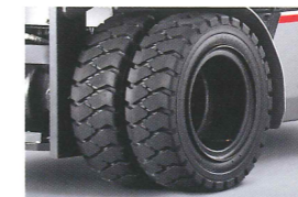
スペシャルダブルタイヤ 不整地や泥ぬい地に適した、太ダブルタイヤです。
