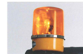
黄色回転灯/赤色回転灯 通常キーONと同時に回転しますが、バック連動タイプやON/OFF切り替えスイッチ付きもあります。
