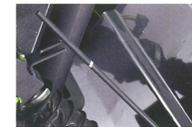
マストチルトゲージ チルト水平作業をサポートします。
