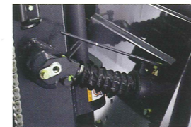
チルトシリンダーブーツ チルトシリンダーを塵埃等から保護します。
