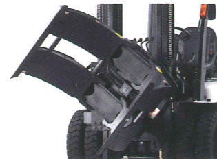
ロールクランプ (ショートアーム可動型/固定型) 円筒物をつかむ。ロール紙の荷役に最適。
