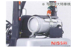
LPG仕様スイングオープン架台 (残量警告表示付)
