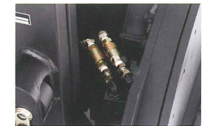
カプラー配管 アタッチメントの脱着を容易にします。
