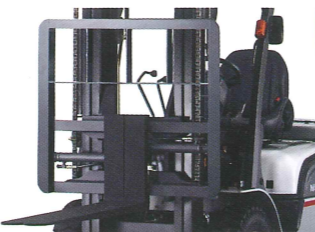
フック式フォークポジショナー (複動型/別動型) レバー操作でフォーク間隔を自由に調整。
