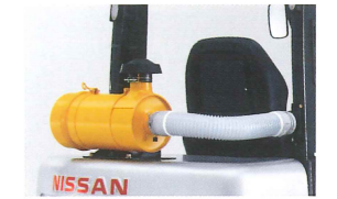
ドナルドソンサイクロパック カウンタウエイト上のエアクリナーを通過した吸入空気を、エンジンルーム内のエアクリナーへ導きます。 ※ ヘッドガード取り付けタイプもあります。
