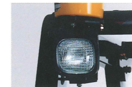
後方作業灯 後方を照射して、夜間や暗い倉庫での作業に威力を発揮します。
