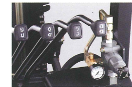
終段減圧弁 クランプ類等のアタッチメントのリリーフ圧を調整します。
