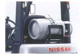
LPG仕様スイングバック架台 (残量警告表示付)
