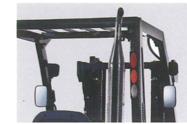
頭上マフラー 排気ガスをオーバーヘッドガード右側上部より排出し、路面のほこりの巻き上げを防ぎます。
