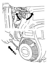
注. 長期間使用しない時は、燃料コックを閉にしてエンジンが自然に停止する のを待ちます。気化器内に残った燃料を使い切ることで、変質やつまり等 を防止します。
